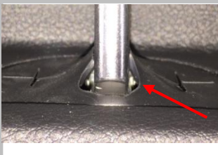
1.8，安装后踏盖会发现原车盖板干涉部分，如图拱起部分。
