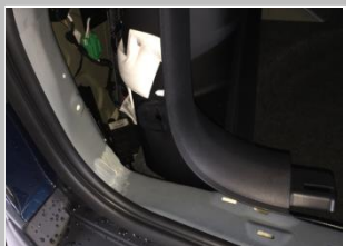
1.7 驱动盒以及拉线布置完成，如图所示，注意：内饰板等对插线后再还原
