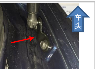
2.2 拆下原车右侧下支架
