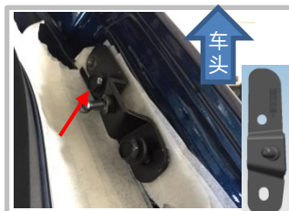
2.4 使用原车 M8 螺栓固定配件支架。
