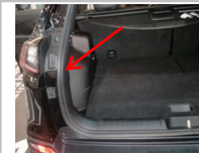
2.13 负极接线需拆掉上图箭头标记地方的内饰，找到一个螺柱(无油漆)然后将我公司的负极线卡在螺柱上
