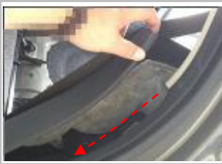
2.4 布正极线 将连接正极的线如图所示，通过尾箱后，把左 C 柱及迎宾踏板掀开，把正极线穿出；(虚线)
