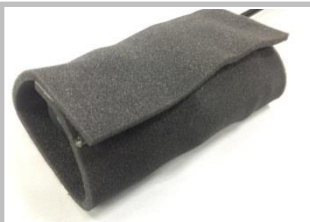
1.5 门锁驱动盒，使用减振棉包裹并粘牢，防止共振，降噪。
