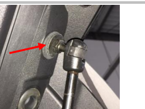
2.3 原车上万向头保留，无需更换，直接使用。
