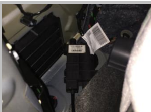
1.6 驱动盒按图示包裹减振棉后放置在尾箱左侧内饰
