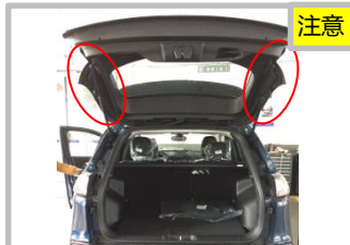
2.1 拆原车气弹簧 把原车左右两边气弹簧拆卸，提示：拆原车撑杆时需有人撑起尾门，防止掉下；
