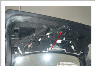
2.15 原车上门锁盖板已拆卸；在尾门上方，箭头位置找到原车信号线插头；注意如图拍摄角度；
