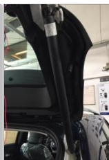
2.6, 如图右侧已装好, 左侧撑杆使用同样方法安装
