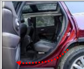
2.5 布正极线：把正极线通过后门迎宾踏板延伸至前门迎宾踏板，掀开胶条把露出来的线隐藏；(虚线)
