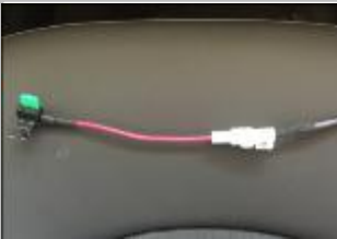
2.11 接正极线：如图示意接正极取电器，用我司正极插头插进原车保险盒内；
