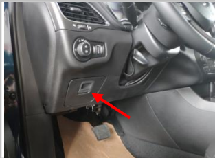
2.7 需拆下主驾驶室此处盖板，正极线束连接于此处位置；
