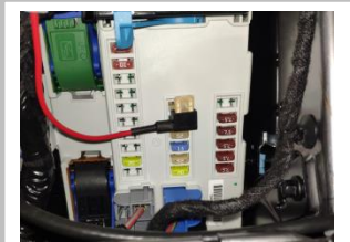
2.12 接正极线：拔下原车插头后，用我司正接取电器转接头插上；
