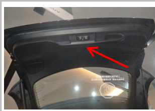
2.14 接信号线：拆下后尾门上盖板，就可以看到一束线和原车门锁相连。
