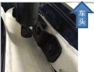
2.5. 把撑杆下固定头卡进支架方向头，
